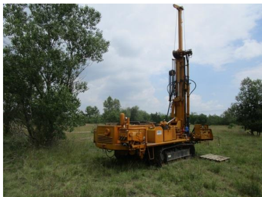
Sonda di perforazione per l'esecuzione dei piezometri
